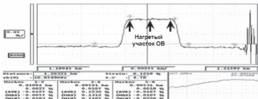
Рисунок 7. – Картина распределения натяжения вдоль ОВ при 100°C
