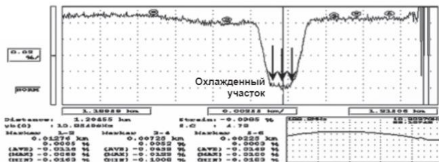
Рисунок 9. – Картина распределения натяжения вдоль ОБ при -10°С
