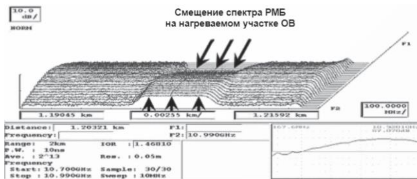
Рисунок 6. – BOTDR – рефлектограмма для участка ОВ при 100°C)
