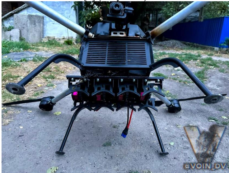
Рисунок 1. – Украинский беспилотный летательный аппарат «Баба-яга», оборудованный под минометные снаряды 82 калибра
