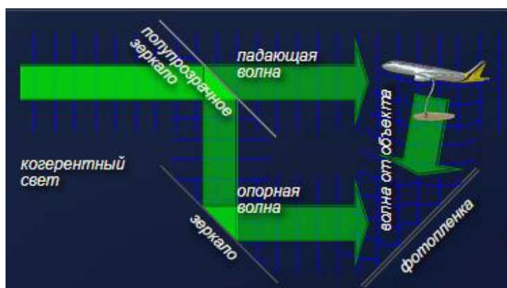
Рисунок 1. – Принцип формирования голограммы
