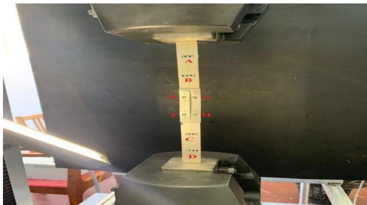
2-сурет. – Бейнеэкстенсометрге арналған белгілері бар үлгінің орны
