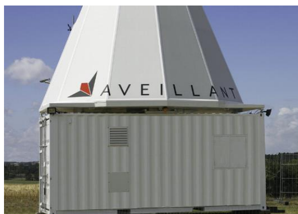
Рисунок 4. – Голографический радар – Theia 384a
