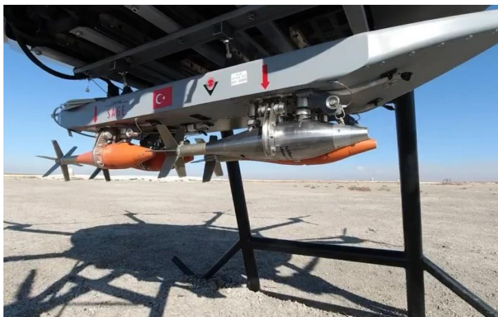
Рисунок 2. – Турецкий беспилотный летательный аппарат "Cargo-150" с подвешенными миномётными минами
